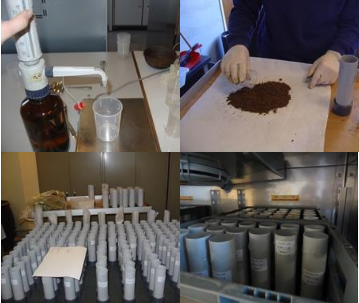
Foto 10. Afmeten van het toe te voegen water (linksboven), mengen van de digestaatproducten doorheen de bodem (rechtsboven), gelabelde buisjes voor de N-mineralisatieproef (linksonder) en de buisjes in de klimaatkast (rechtsonder).
