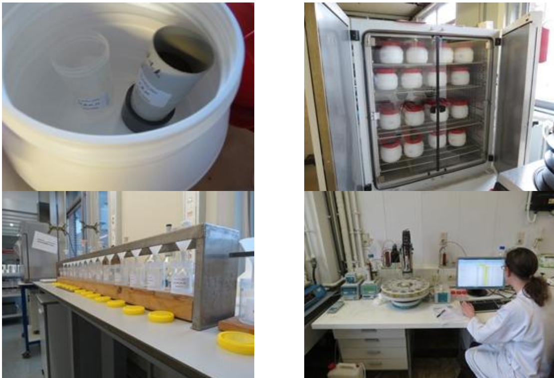
Foto 11. Buisje met bodem-organische meststof mengsel en potje met NaOH-oplossing om de geproduceerde CO_2 in op te vangen samen in een afsluitbaar tonnetje (linksboven), tonnetjes in de klimaatkast (rechtsboven), filtreren van neergeslagen carbonaten uit de NaOH-oplossing na toevoeging van BaCl (linksonder) en de automatische titratie met HCl ter bepaling van de hoeveelheid geproduceerde CO_2 -C (rechtsonder).
